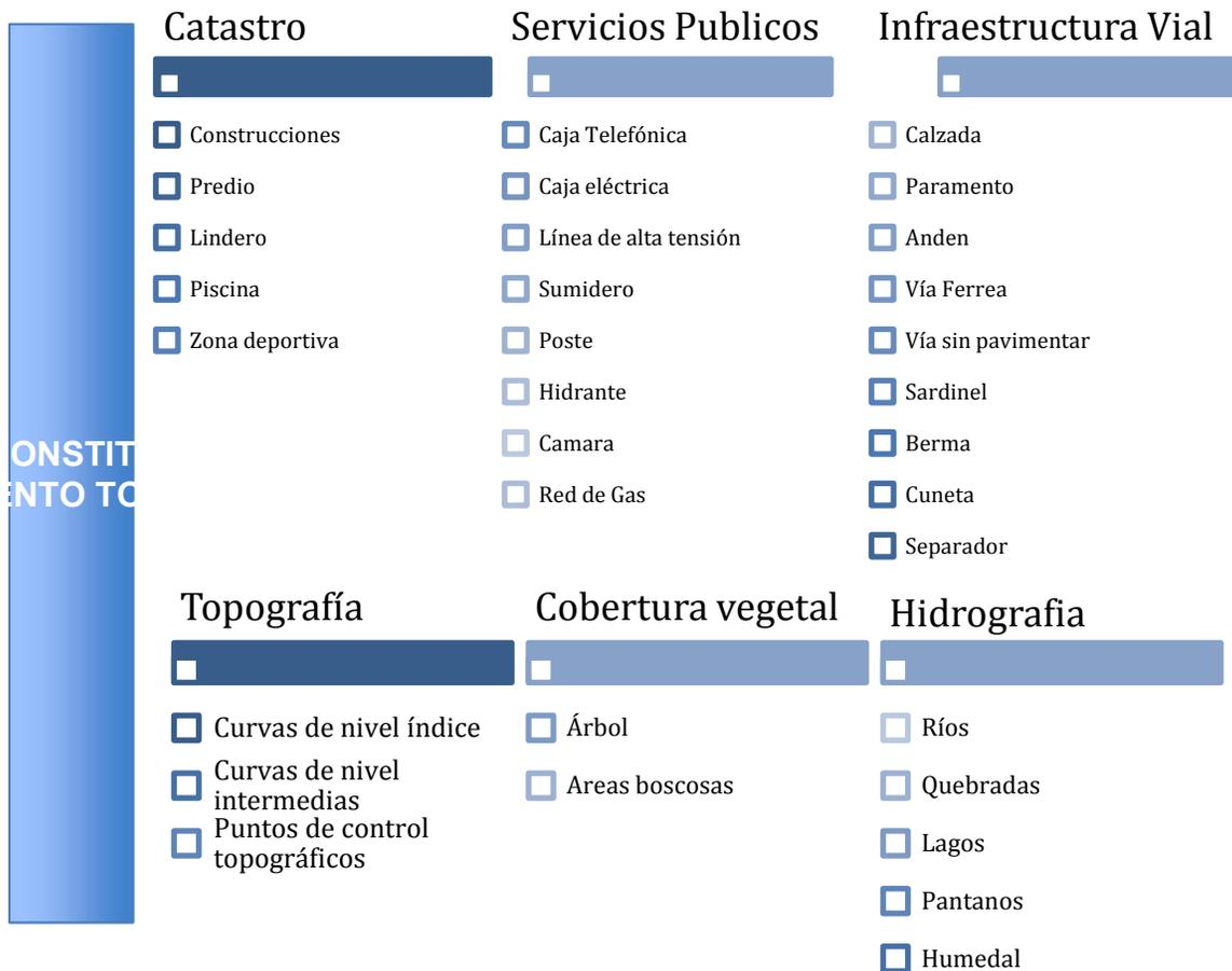
**Figura 1. Elementos de un levantamiento topográfico**
