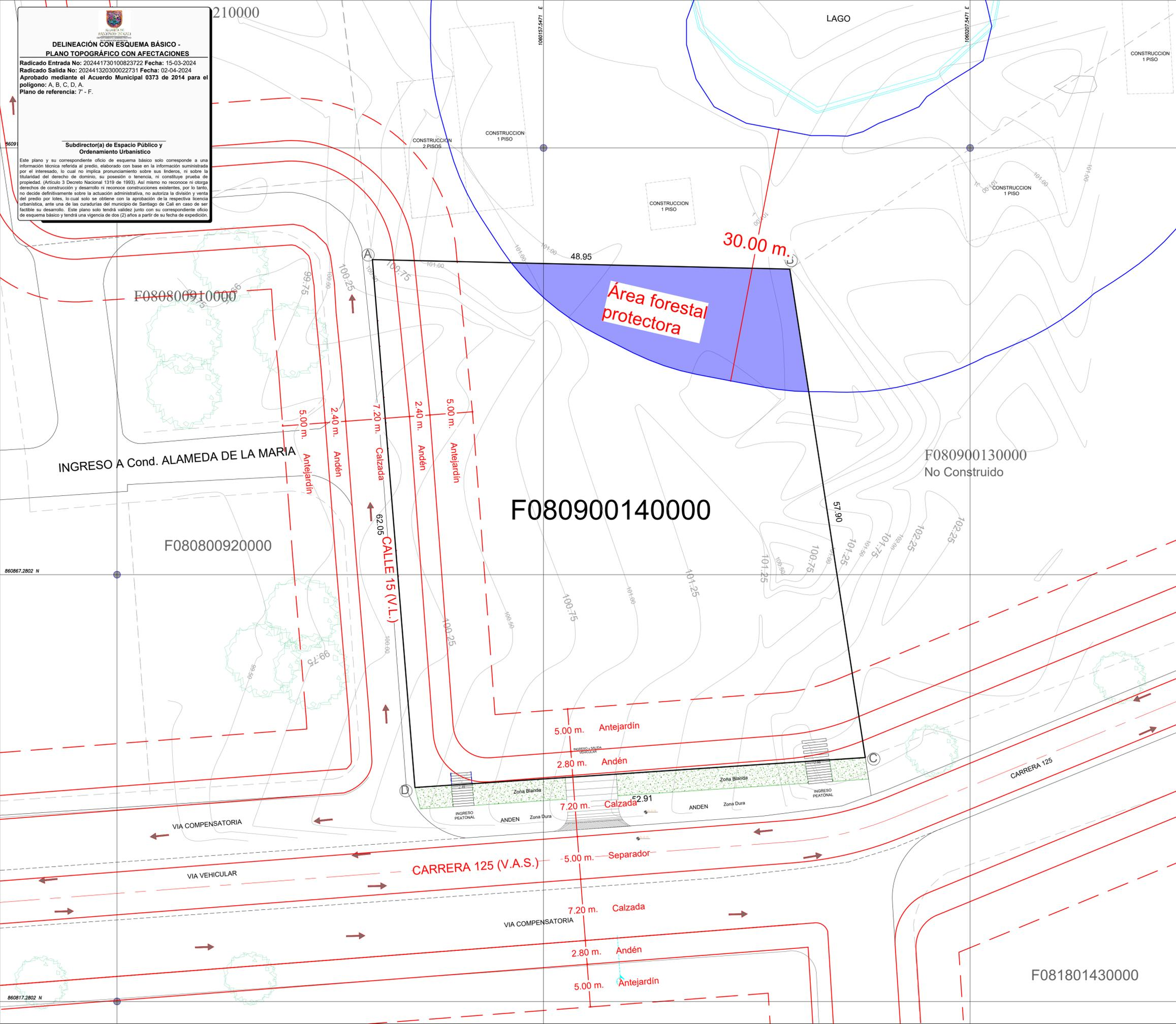
**DELINEACIÓN CON ESQUEMA BÁSICO - PLANO TOPOGRÁFICO CON AFECTACIONES**
