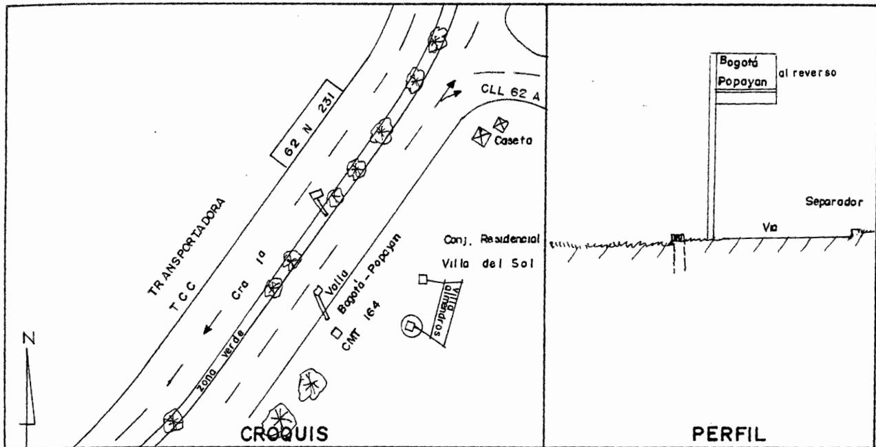
DESCRIPCION: Sobre la Cra. 1ª, sentido S-N, junto a una valla que indica Bogotá Popayán (Aprox. 1.2) y diagonal a la plaza 62N-231, se halla enterrado un mojón de 0.25 x 0.25 mts en concreto y con placa incrustada y marcada con C.M.P.S.I.R.O. MUNICIPAL, CALI-C.M.I-164-CROCAT-1.998. El azimut desde la pata de valla (S/N) de Villa Almenares al C.M.I = 205°.
