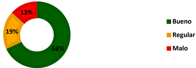
Figura 68 Presencia y valoración de Piel de cocodrilo en vías arterias secundarias
